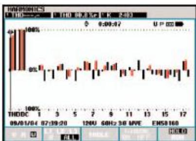
K 系数用于衡量谐波的发热作用对变压器负载和损耗的影响。K-1 是标准变压器的基准数值。K-4 是“正常”发热量的四倍。K 级变压器是专门为处理谐波而设计的。
